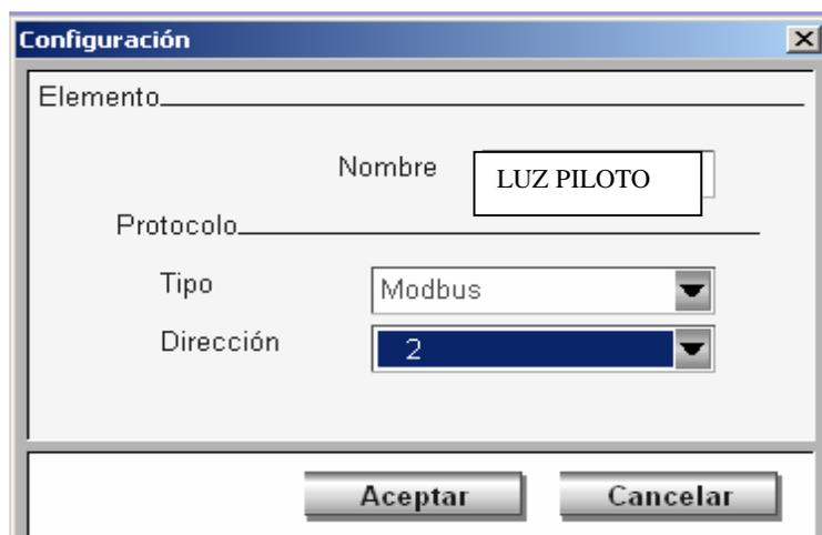
**Figura 18-2.** Ventana de Configuración de Esclavo Modbus
