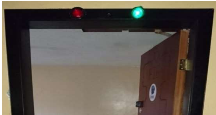
Figura 33-2: Indicador de puerta abierta. Realizado por: Sebastián Cuenca; Alex Manotoa; 2017.
