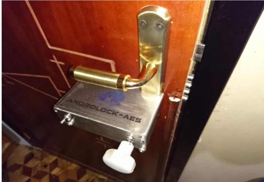
Figura 11-2: Mecanismo real instalado sobre el bombín de la cerradura Realizado por: Sebastián, Cuenca; Alex, Manotoa; 2017
