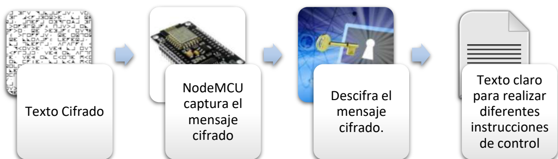
Figura 51-2: Proceso de descifrado en el módulo NodeMCU Realizado por: Sebastián Cuenca; Alex Manotoa; 2017.
