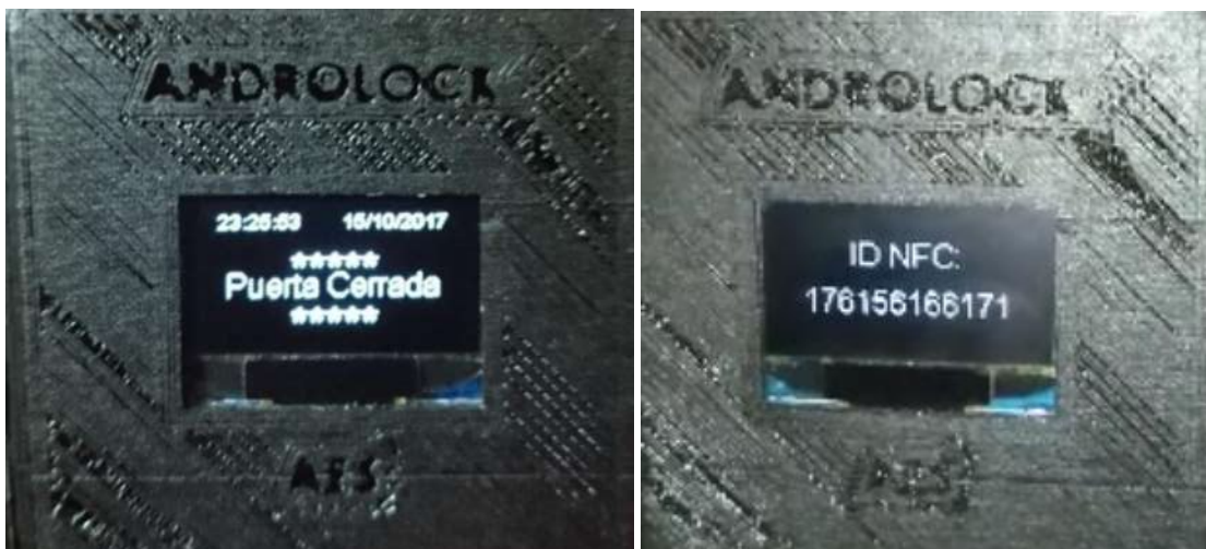
Figura 29-2: Funcionamiento de pantalla OLED SSD1306
