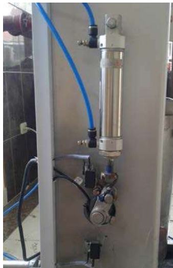
Figura 29-3: Sistema de volteo del reactor. Fuente: Paucar Elvis; Masaquiza Bryan; 2017.
