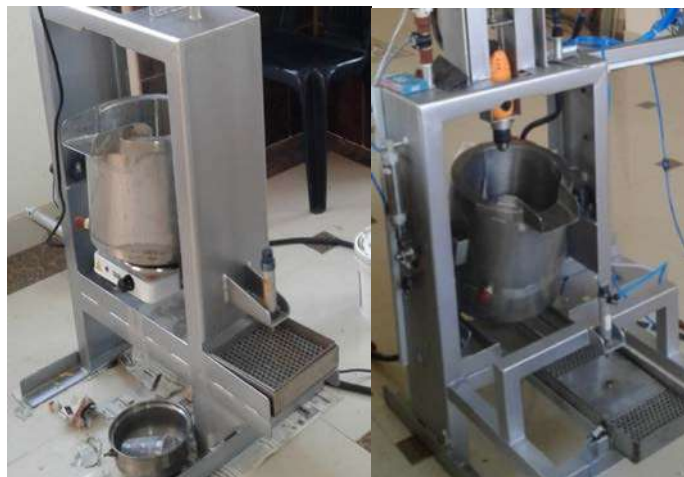
Figura 10-3: Modificación del sistema de transporte y posicionamiento de la bandeja.
