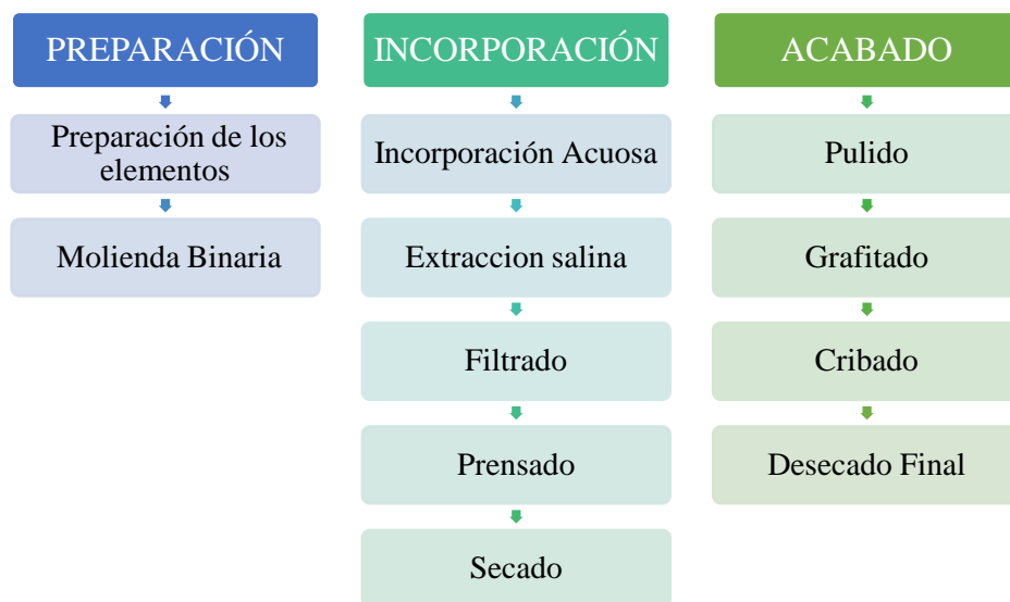
Figura 3-2: Gráfico del proceso por vía húmeda.
