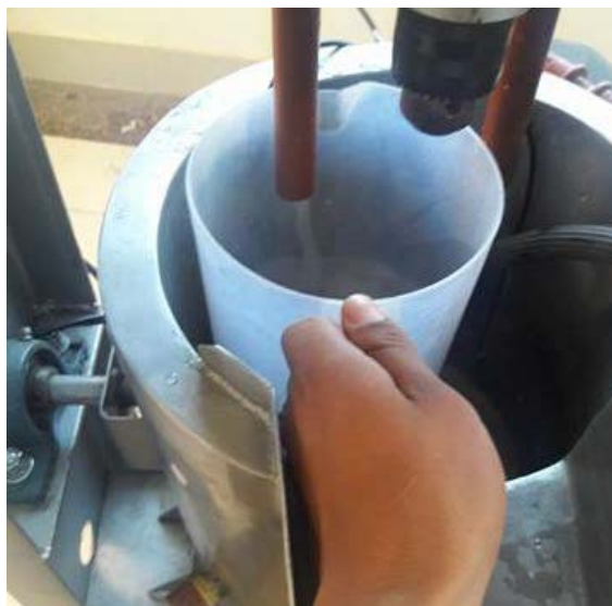
Figura 7-3: Prueba de dosificación de alcohol. Fuente: Paucar Elvis; Masaquiza Bryan; 2017.
