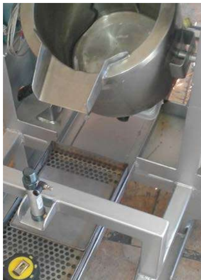
Figura 12-3: Sistema de prensado sin guías. Fuente: Paucar Elvis; Masaquiza Bryan; 2017.
