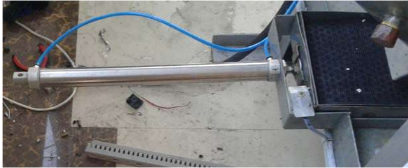
Figura 11-3: Sistema de transporte y posición de la bandeja. Fuente: Paucar Elvis; Masaquiza Bryan; 2017.
