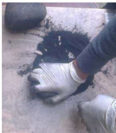
Figura 15-3: Obtención de mezclas binarias N-C y C-S por conminución.
