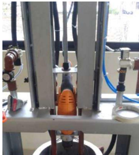
Figura 26-3: Posicionamiento del agitador. Fuente: Paucar Elvis; Masaquiza Bryan; 2017.
