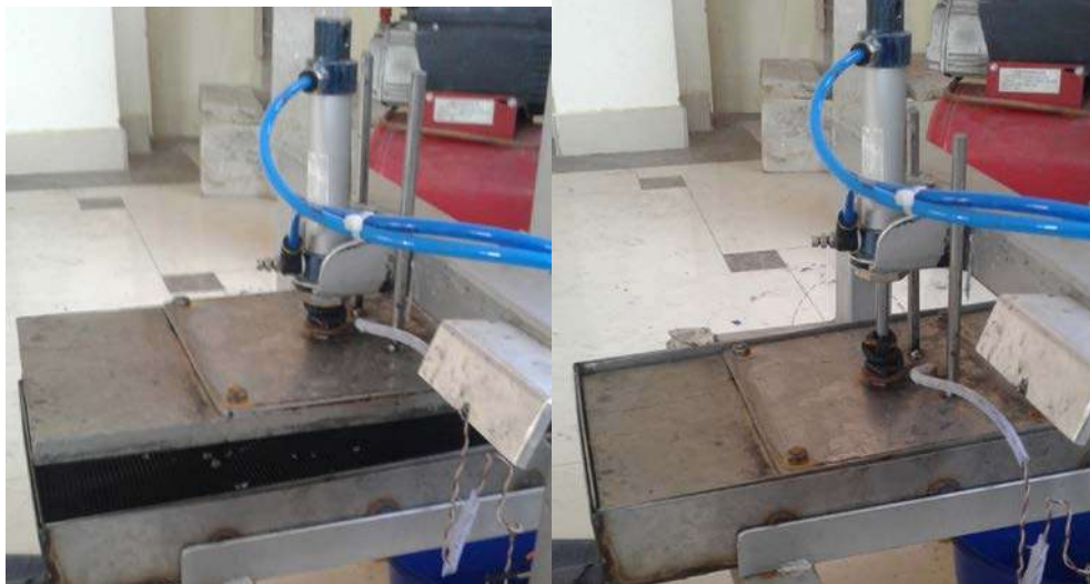
Figura 13-3: Sistema de prensado con guías alrededor del pistón. Fuente: Paucar Elvis; Masaquiza Bryan; 2017.
