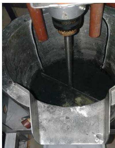
Figura 16-3: Adición de mezclas binarias en el reactor.
