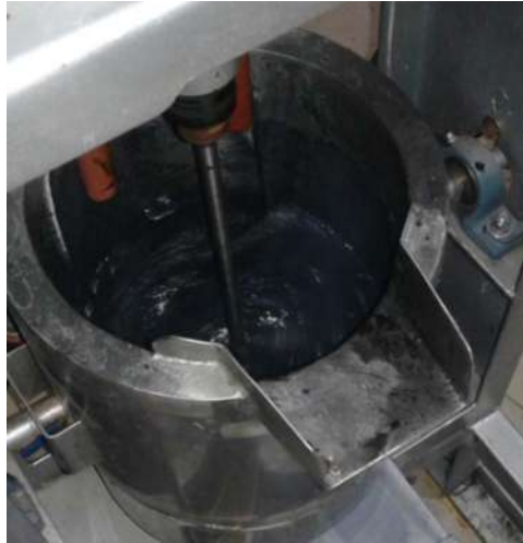
Figura 6-3: Calentamiento y agitación en el reactor. Fuente: Paucar Elvis; Masaquiza Bryan; 2017.
