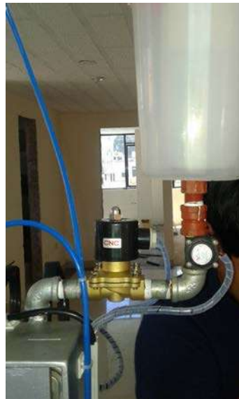
Figura 27-3: Sistema de dosificación de alcohol.
