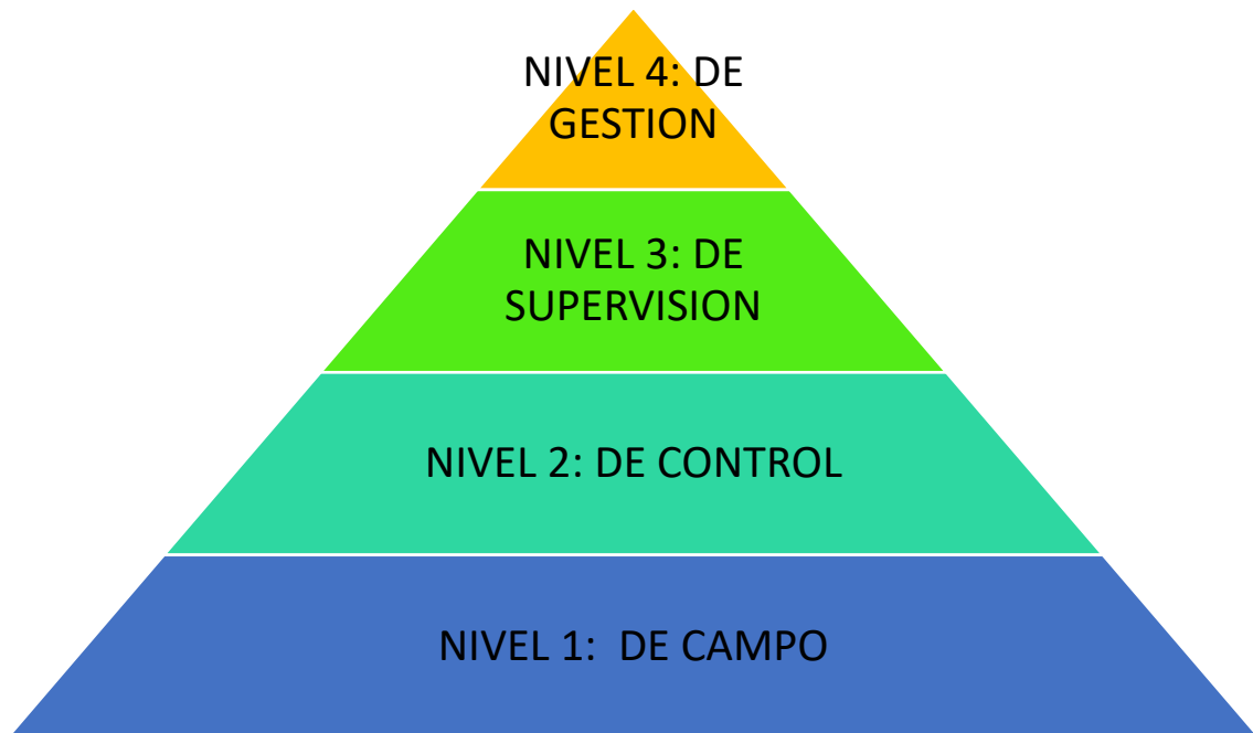
Figura 6-1: Pirámide de la Automatización.
