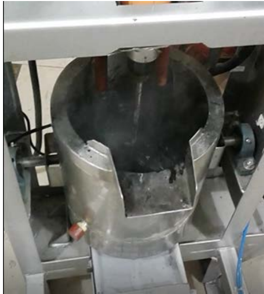
Figura 17-3: Agitado y calentamiento de la mezcla.
