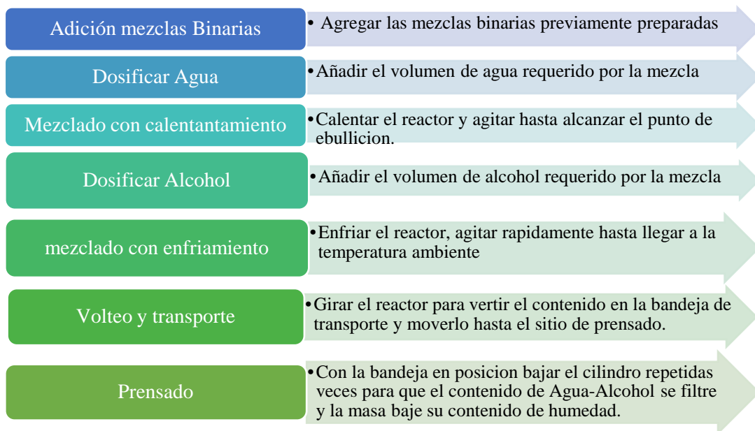
Figura 6-2: Etapas de proceso óptimo del sistema de automatización.
