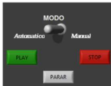
Figura 2: HMI para control manual y automático
