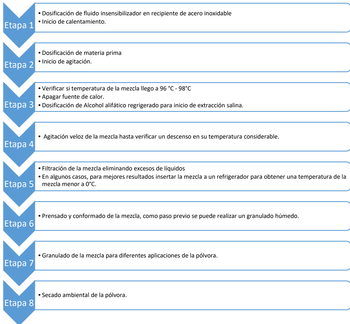
Figura 2-2: Etapas de fabricación de pólvora por vía húmeda.
