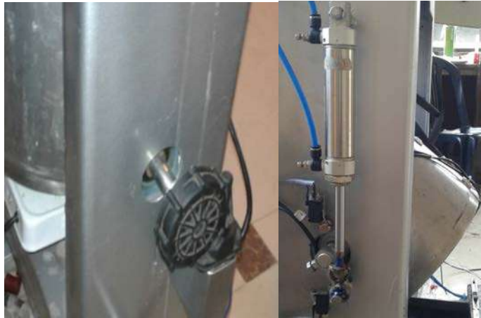
Figura 9-3: Sistema de volteo con motor DC y con cilindro de doble efecto.
