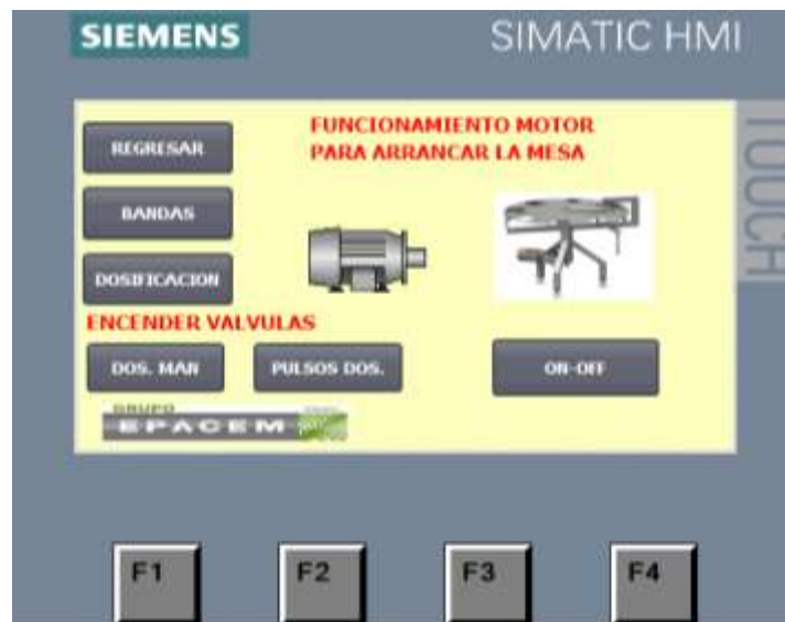
Figura 20-2 Pantalla de accionamiento de la mesa modo manual
