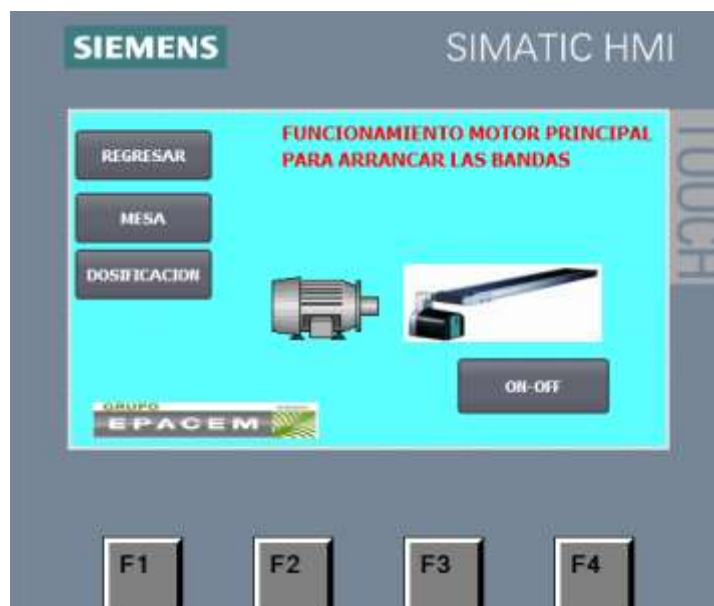
Figura 19-2 Pantalla de accionamiento de bandas modo manual
