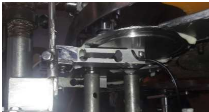
Figura 21-1 Soporte de las celdas de carga
