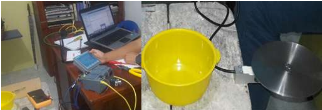
Figura 11-2 Calibración de los sensores de peso
