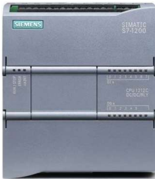
Figura 28-1 PLC SIEMENS S7 1200
