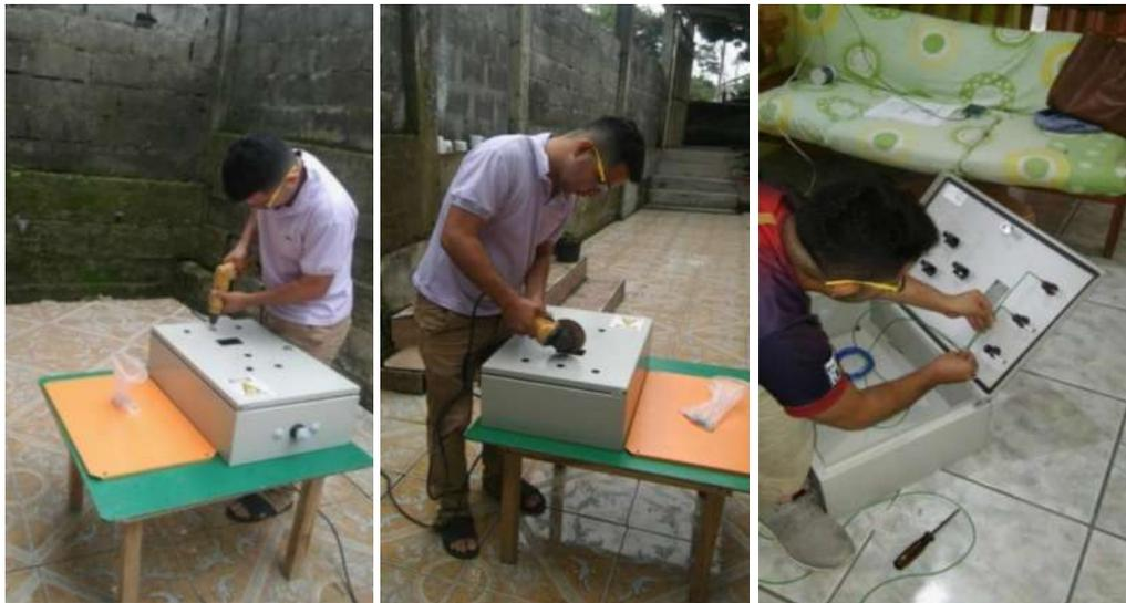
**Figura 15-2:** Realización de orificios y colocación de elementos
