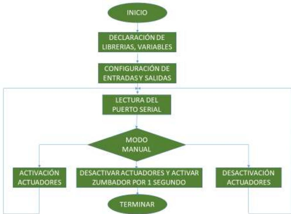
**Figura 27-2:** Diagrama del proceso del sistema manual de Nebulización y Riego
