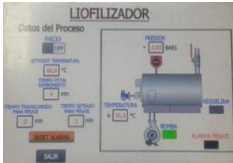
Figura 34 - 2 Pantalla de activación de la bomba de vacío Realizado por: VELASCO, Deicy, 2017
