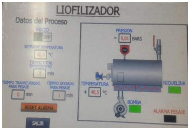
Figura 35 - 2 Pantalla de activación de resistencia y bomba de vacío Realizado por: Velasco, Deicy; 2017
