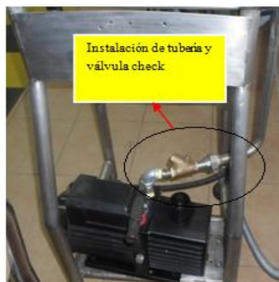
Figura 8 - 2 Tubería con válvula check para la bomba Realizado por: VELASCO, Deicy, 2017
