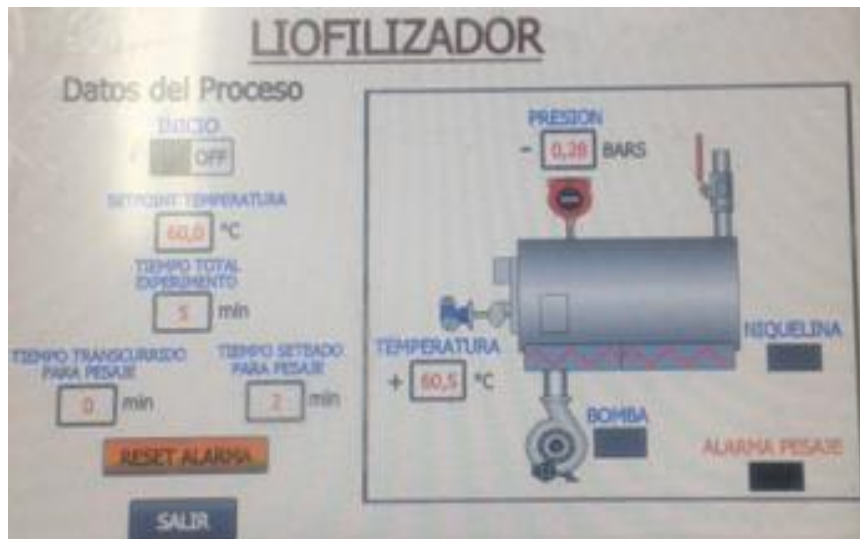
Figura 37 - 2 Pantalla de desactivación de actuadores Realizado por: VELASCO, Deicy, 2017
