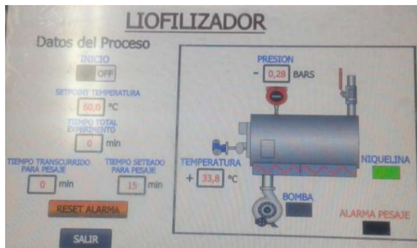
Figura 33 - 2 Pantalla de activación de la resistencia Realizado por: VELASCO, Deicy, 2017
