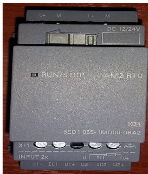
Figura 11 - 1 Módulo de ampliación AM2 RTD Realizado por: VELASCO, Deicy, 2017
