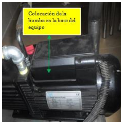
Figura 7 - 2 Colocación de bomba de 1 Hp Realizado por: VELASCO, Deicy, 2017
