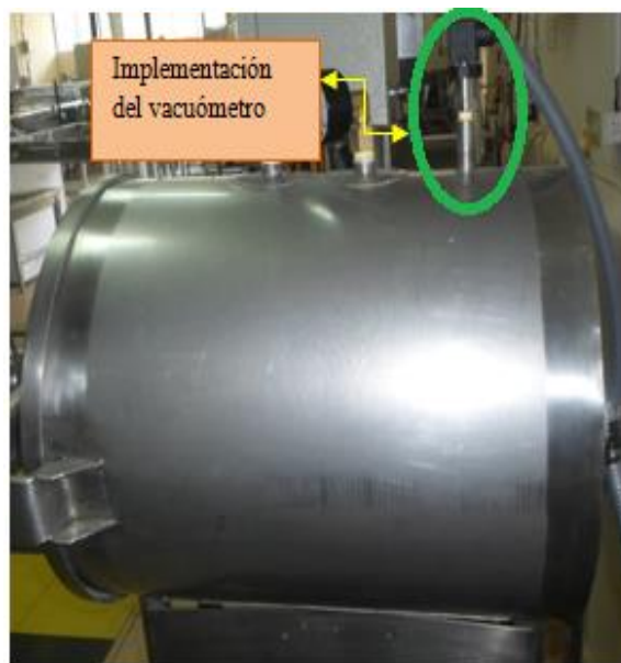
Figura 18 - 2 Implementación del Vacuómetro Realizado por: VELASCO, Deicy, 2017
