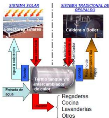
**Figura 2.35:** Elementos de un sistema de ACS con energía solar.
