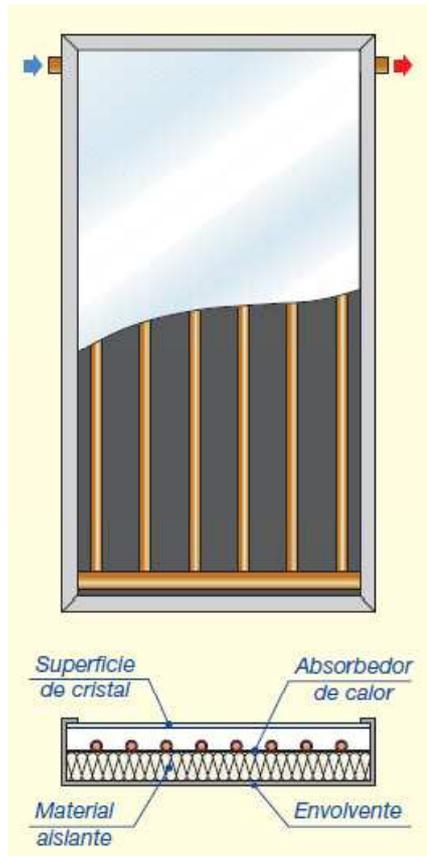
**Figura 2.36:** Elementos de un colector solar plano.
