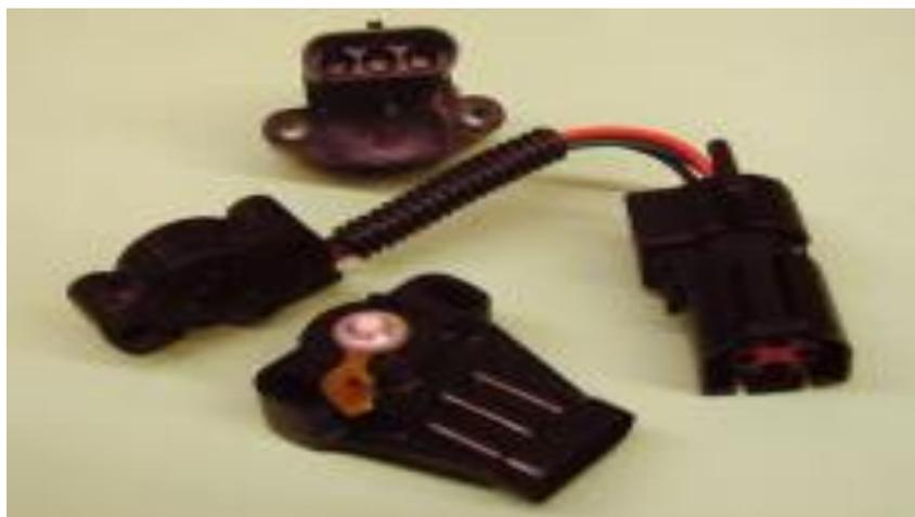
**Figura 16 – 1:** Sensor de Posición de Aceleración (TPS) Hyundai Accent
