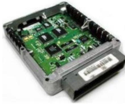
**Figura 1 - 1:** Unidad de Control de Motor Electrónica de Motor.
