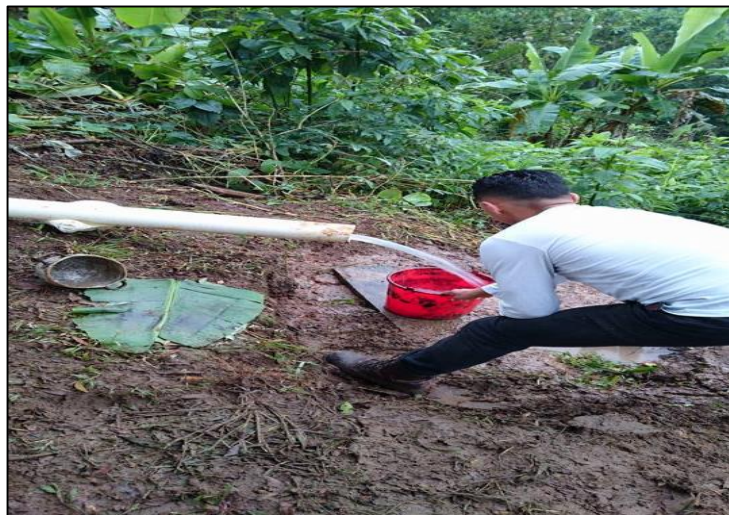
Gráfico 2-1. Medición de caudales por método volumétrico.
