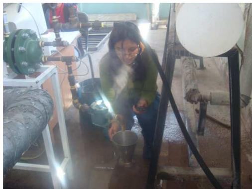
Figura. 5.15 Medición del caudal de condensado
