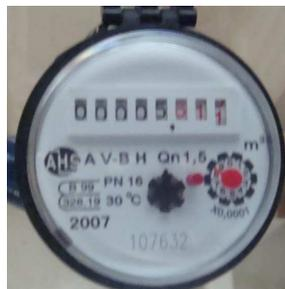
**Figura. 5.6 Medidor de agua**
