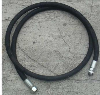
**Figura. 5.5 Manguera de alta presión**
