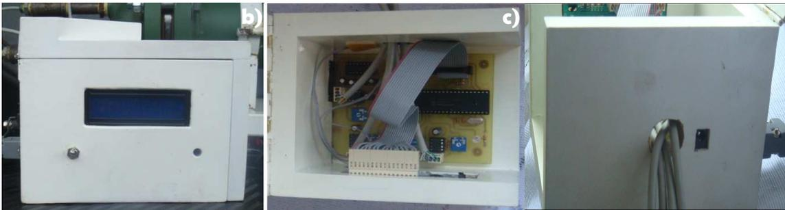
**Figura. 4.10** Indicador de temperaturas. a) Cara frontal; b) Interior; c) Cara posterior
