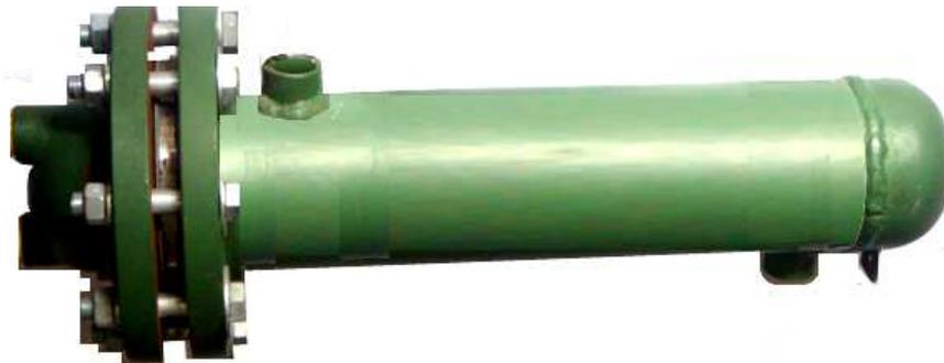
**Figura. 4.8 Intercambiador de calor de coraza y tubos terminado**
