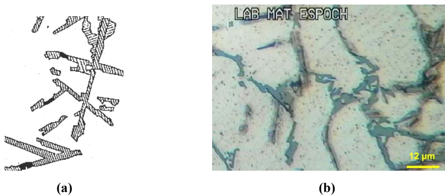
Figura 4.4: (a) Representación de la estructura original de silicio ramificado. (b) Microestructura de una aleación de aluminio ASTM 355.
