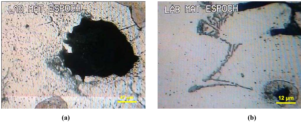
Figura 4.25: Microestructura de una aleación de aluminio ASTM 40E sometida a tratamiento térmico de envejecimiento natural (T4) atacada con Kellers durante 20 segundos: (a) 100x y (b) 400x.
