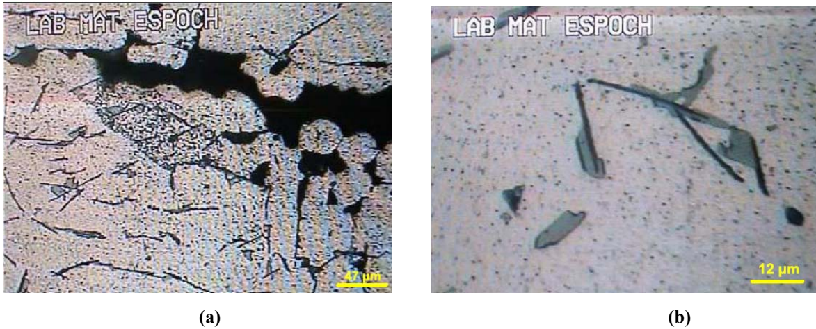
Figura 4.19: Microestructura de una aleación de aluminio ASTM 40E en condiciones de fundido (F), atacada con Kellers durante 20 segundos: (a) 100x y (b) 400x.
