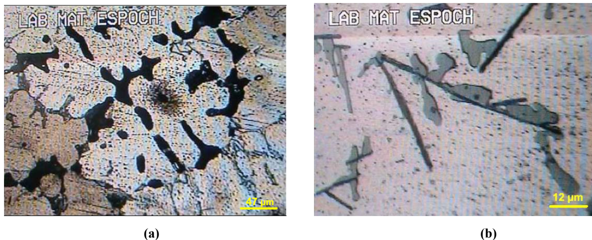
Figura 4.16: Microestructura de una aleación de aluminio ASTM 40E en condiciones de fundido (F), atacada con Kellers durante 20 segundos: (a) 100x y (b) 400x.
