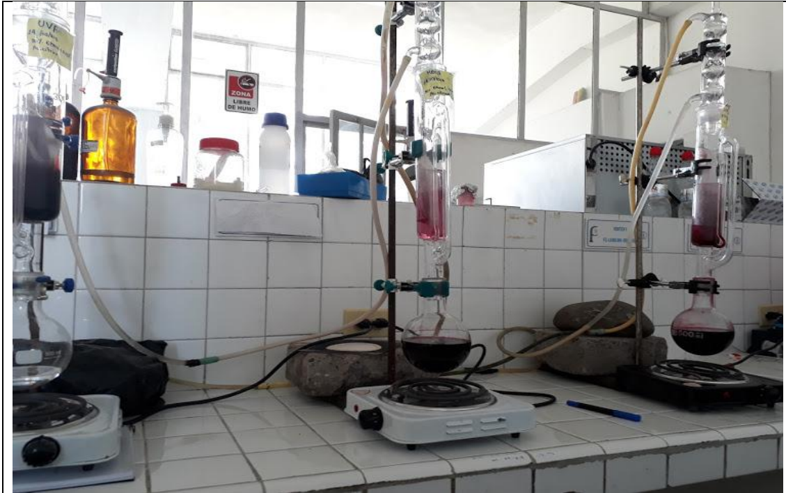
Gráfico F3: Extracción del colorante de los diferentes productos en materia fresca.
