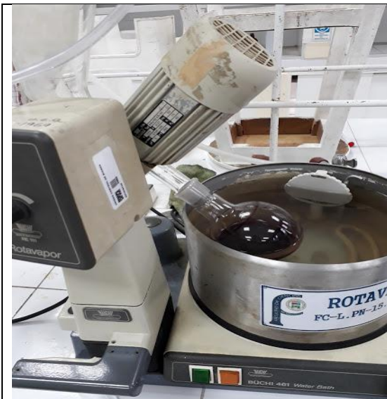
Gráfico H1: Colocación del solvente más colorante en el rotavapor.
