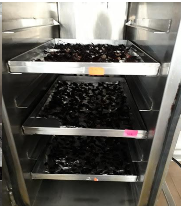
Gráfico D2: Bandejas de la materia prima en el secador en bandeja tipo armario. Fuente: Laboratorio de Procesos Industriales, ESPOCH
