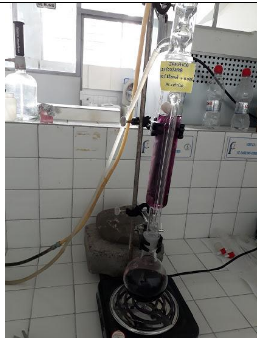
Gráfico F2: Soxhlet en el proceso de extracción.
