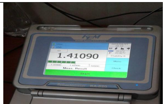
Gráfico L2: Medición de índice de refracción del colorante.
