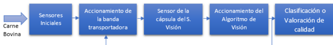
Figura 1-2: Diagrama de bloques del funcionamiento del prototipo
