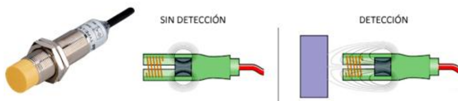
Figura 5-2: Comportamiento de un sensor Inductivo
