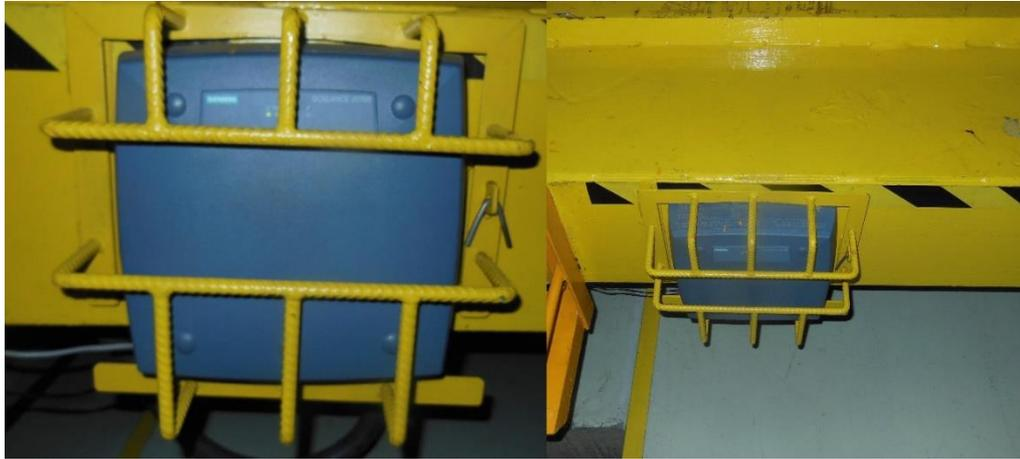
**Figura 39-2:** Access Point montado en el chasis del Transportador
