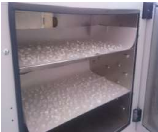
Desecación de la muestra vegetal en la estufa redLINE by BINDER
