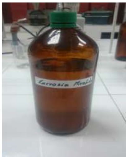
Maceración de los bulbos secos y triturados con metanol
