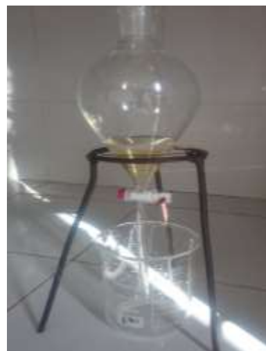
Extracción de alcaloides con acetato de etilo
