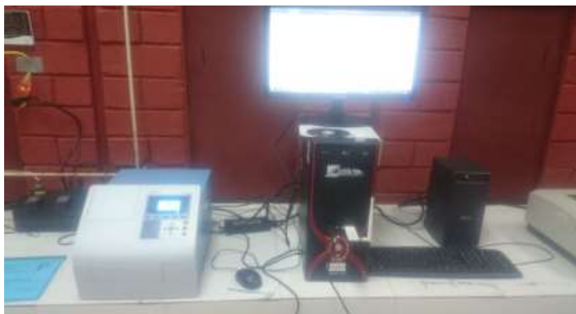
Análisis de la microplaca en el espectrofotómetro MULTISKAN GO Thermo Scientific.
