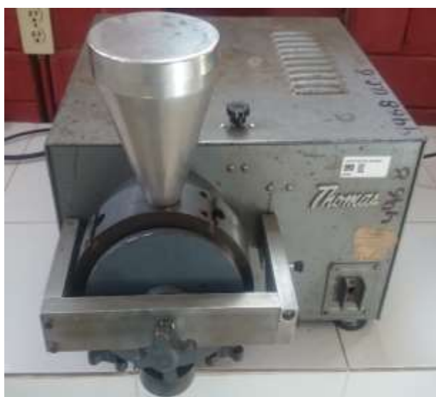
Molino de cuchillas giratorias Arthur H. Thomas C.O. modelo Willey Mill
