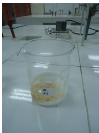
Adición de sulfato de sodio anhidro y goma arábica para absorber el agua restante de la muestra.
