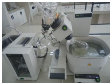
Recuperación del solvente por aplicación de presión y temperatura
