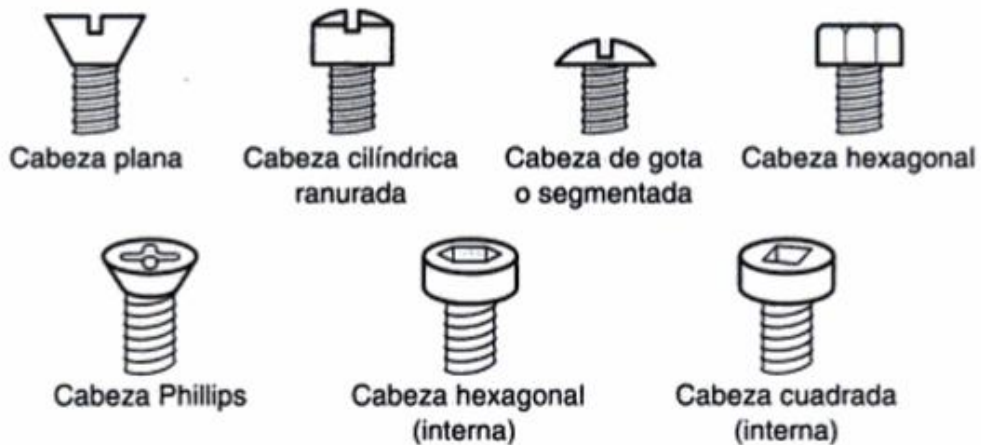
Figura 22: Diferentes estilos de cabeza de pernos y tornillos Nota. Fuente: (Groover, 1997, pág. 791)
