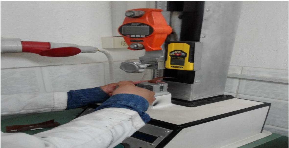
Figura 3: Máquina para el test de resistencia a la tensión.
