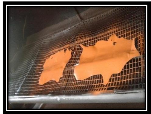
Prensado ( $T^{\circ}=80^{\circ}\text{C}$ ; presión=100atm; retención = 3 segundos)
