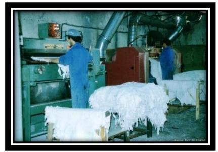
Pesaje, Rehumectado, Neutralizado y Lavado (Acabados en húmedo)
