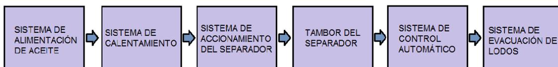
**Figura 4-1** Sistemas del módulo de separación de aceite
