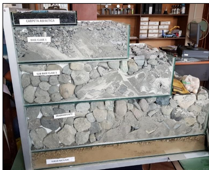
Fotografía 7: Modelo de un diseño de calzada. Fuente: (Consejo Provincial de Morona Santiago, 2018).
