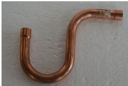
Figura 3.13 Sifón de tubería de cobre.
