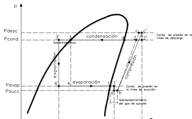
Figura 2.6 Diagrama presión-entalpía del ciclo real de refrigeración. [9]
