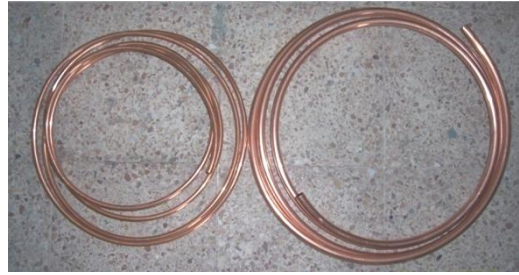
Figura 3.12 Tubería de cobre flexible de cobre, 3/8" tipo L y 5/8" tipo M.
