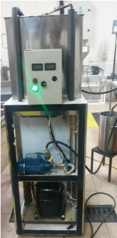
Gráfico 16-3: Sistema de enfriamiento Realizado por: ORTA F; PAUCAR M.
