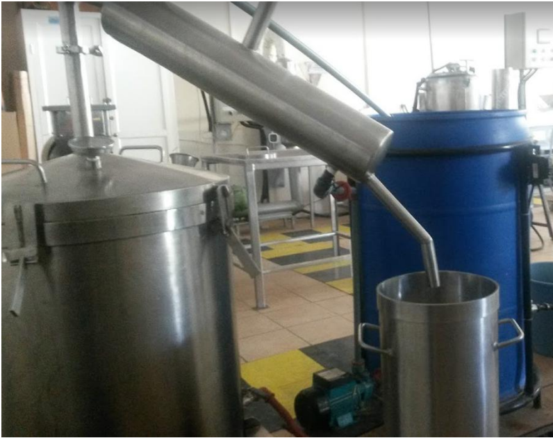
Gráfico 1-1: Equipo de Extracción de aceite esencial
