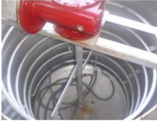
**Figura 9-3** Evaporador con serpentín horizontal
