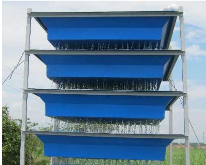
Figura 7-3 Aireadores de bandeja Fuente: http://nesvin-aireacion.blogspot.com/
