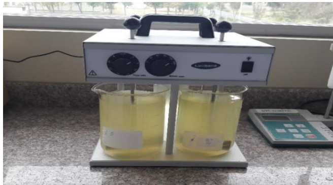
Figura 2-1 Test de jarras con PAC y poli electrolito
