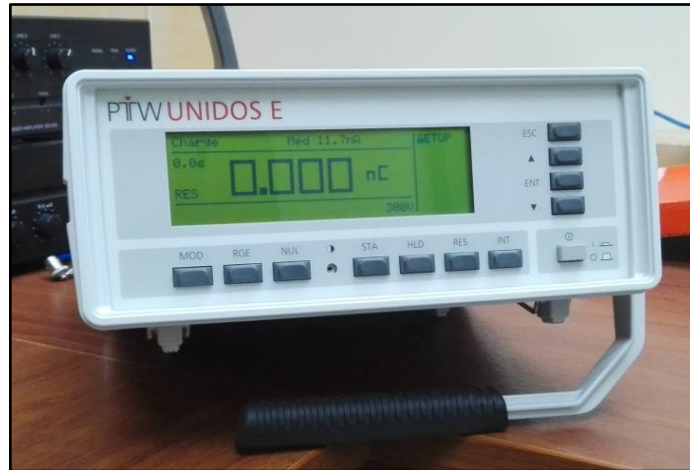
Figura 21-2: Electrómetro multicanal para medidas de dosimetría absoluta y control de calidad en radioterapia.
