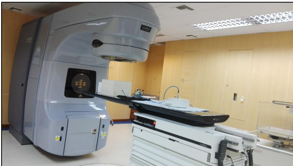
Figura 12-3: Irradiación al fantoma de agua sólida PTW 29672/U19.
