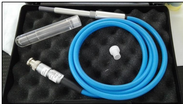
Figura 20-2: PTW FARMER cámara delgada de ionización.
