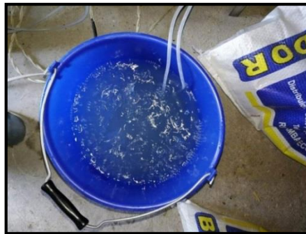
Fotografía 2-2: Aireación del agua residual
