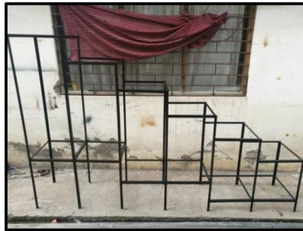
Fotografía 6-2: Soporte de ángulo de hierro
