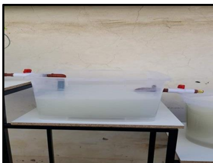
Fotografía 14-2: Trampa de grasa
