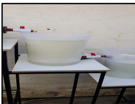
Fotografía 15-2: Sedimentación del efluente
