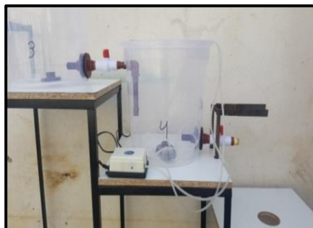
Fotografía 10-2: Tanque de aireación
