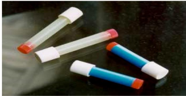
Figura 4-1 Tubos pasivos para \text{NO}_2 (color blanco) y Tubos pasivos para \text{O}_3 (color azul)
