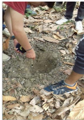
Fotografía 3D: Muestreo por calicatas aproximadamente 30 cm de profundidad.
