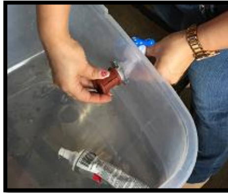
Fotografía 6-3: Colocación de la rosca y pegamento.
