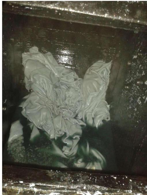
Anexo 19. Proceso del descarnado, desencalado y segundo piquelado de cueros vacunas para la obtención de tapicería utilizando diferentes niveles de *Caesalpinia spinosa* (tara) aplicando el método convencional.
