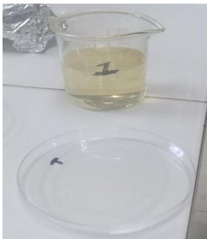
**Gráfico 6-G:** Solución formadora de bioplásticos en la caja Petri.
