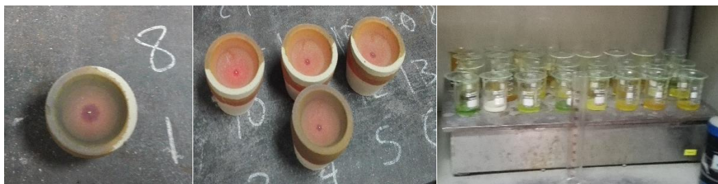
Fotografía 11.3: Proceso químico para la obtención del doré y decantado del nitrato de plata. Elaborado por: Aciptio, A. (2017)
