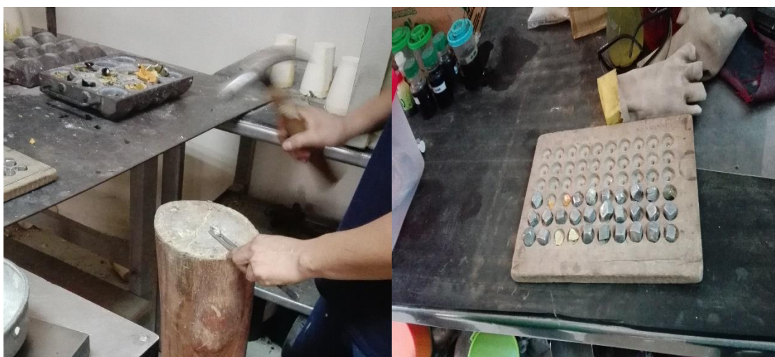
Fotografía 10.3: Retiro de escorias e impurezas del régulo. Elaborado por: Acipio, A. (2017)
