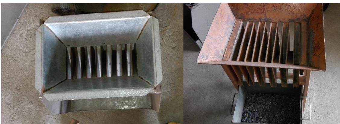
Fotografía 3.3: Proceso de cuarteado con el cuarteador mecánico. Elaborado por: Acipio, A. (2017)
