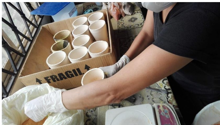
Fotografía 5.3: Preparación de los Crisoles y adición del Flux (fundente). Elaborado por: Acipio, A. (2017)
