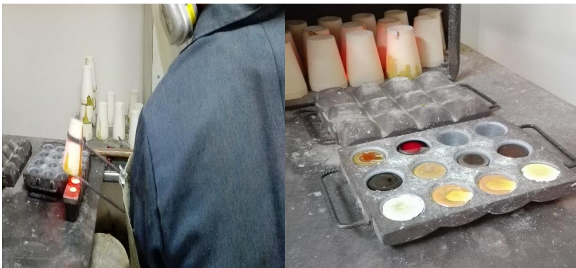
Fotografía 9.3: Colocación de las muestras fundidas en las payoneras y enfriado al ambiente. Elaborado por: Acipio, A. (2017)
