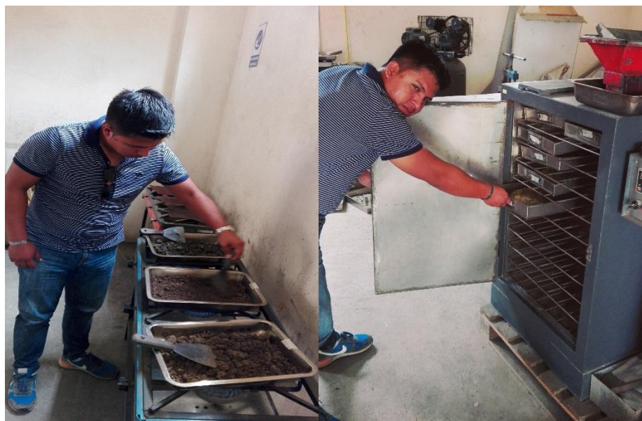
Fotografía 2.3: Secado de las muestras de sedimentos a 110°C. Elaborado por: Acipio, A. (2017)
