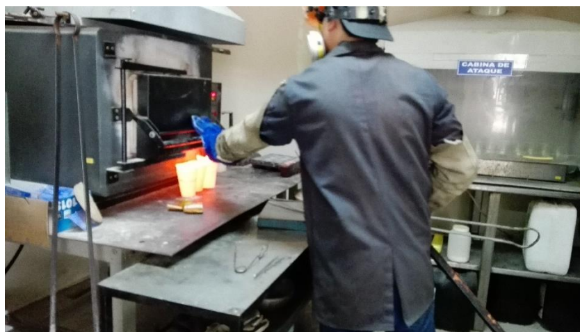
Fotografía 8.3: Colocación de las muestras preparadas al horno para su fundición. Elaborado por: Acipio, A. (2017)
