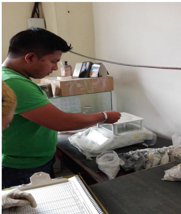
Fotografía 6.3: Pesaje de 25g de muestra de sedimento. Elaborado por: Acipio, A. (2017)
