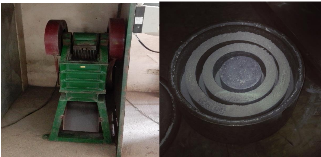
Fotografía 4.3: Proceso de trituración secundaria y pulverización de la muestra. Elaborado por: Acipio, A. (2017)
