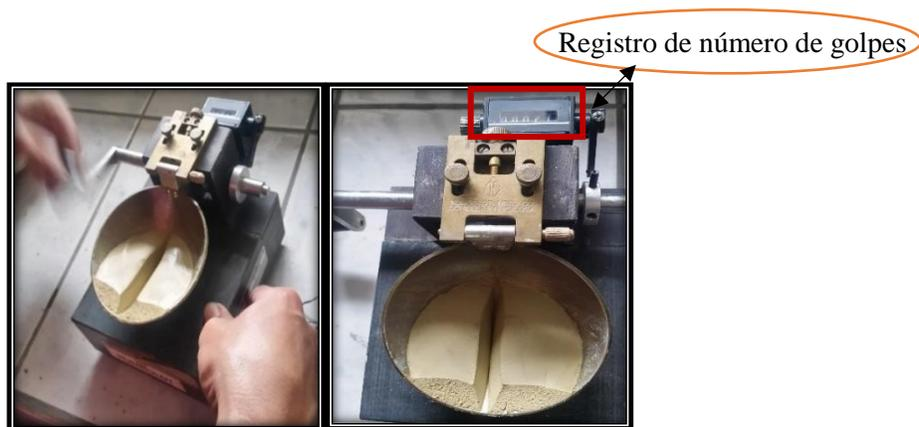
**Fotografía 19-4:** Ensayo del Limite Liquido (6)
