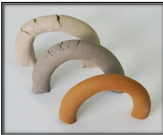
**Figura 5-3:** Método para comprobar la plasticidad de una arcilla en campo
