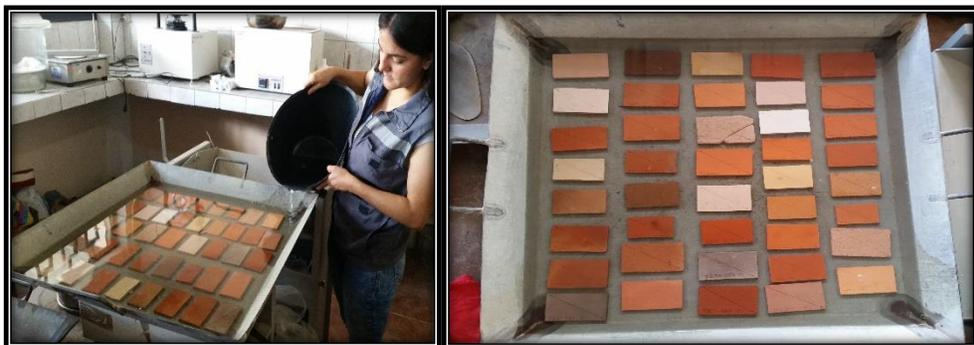
**Fotografía 40-4:** Ensayo de absorción paso (2)
