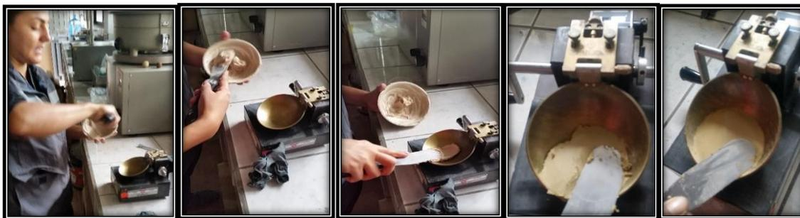
**Fotografía 17-4:** Ensayo del Limite Liquido (4)
