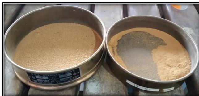
**Fotografía 23-4:** Ensayo del Limite Plástico paso (1)
