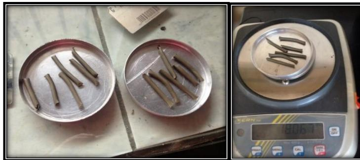
**Fotografía 26-4:** Ensayo del Limite Plástico paso (4)
