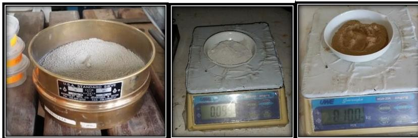
**Fotografía 14-4:** Ensayo del Límite Líquido paso (1)
