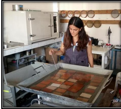
**Fotografía 41-4:**Ensayo de absorción paso (3)
