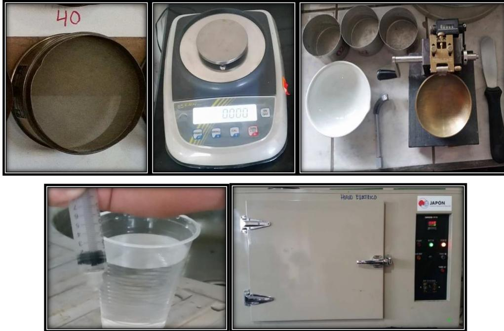
**Fotografía 13-4:** Instrumental para el Ensayo del Límite Líquido
