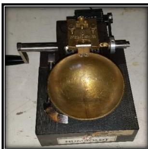
**Fotografía 16-4:** Ensayo del Limite Liquido paso (3)
