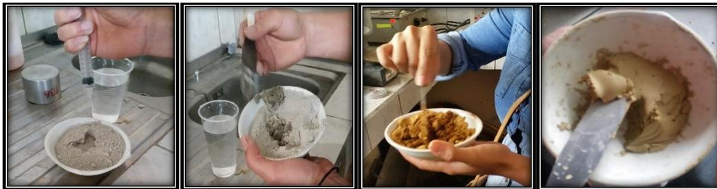
**Fotografía 15-4:** Ensayo del Limite Liquido paso (2)
