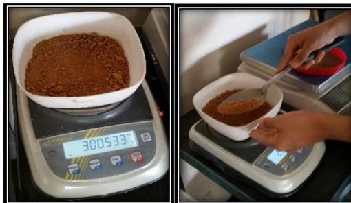
**Fotografía 5-4:** Ensayo Granulométrico paso (2)
