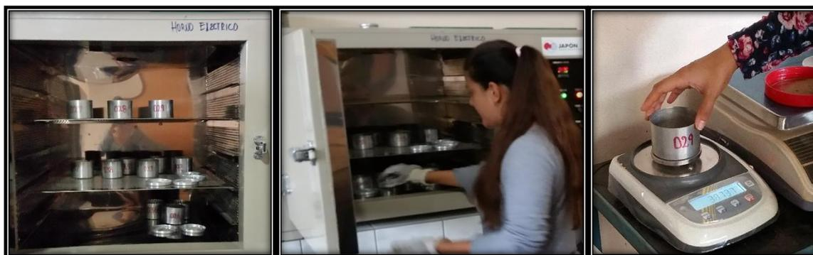
**Fotografía 21-4:** Ensayo del Limite Liquido (9)
