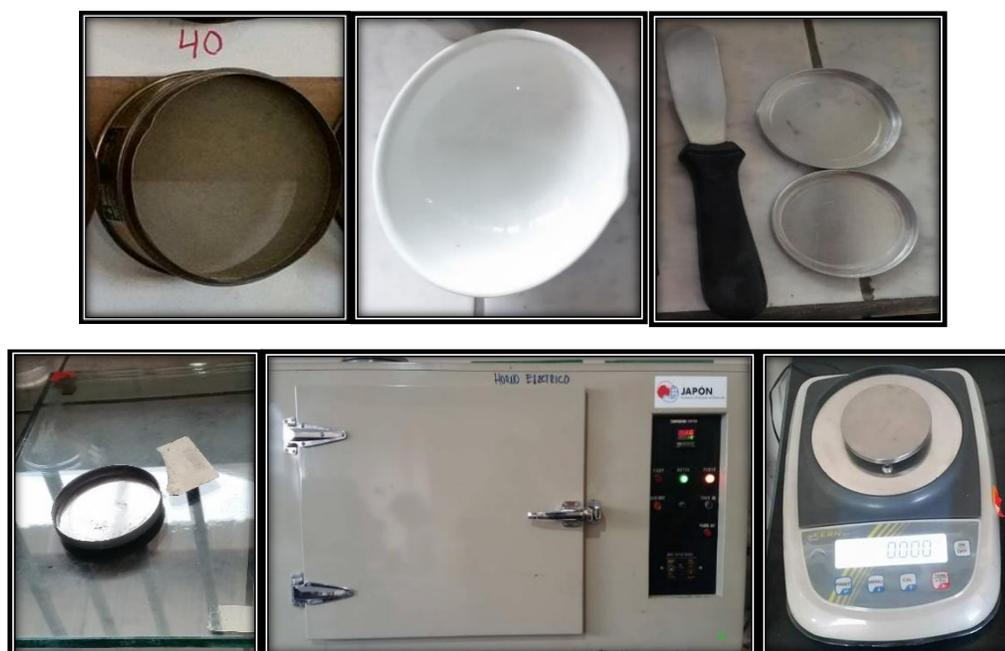
**Fotografía 22-4 : Instrumental para el Ensayo del Límite Plástico**
