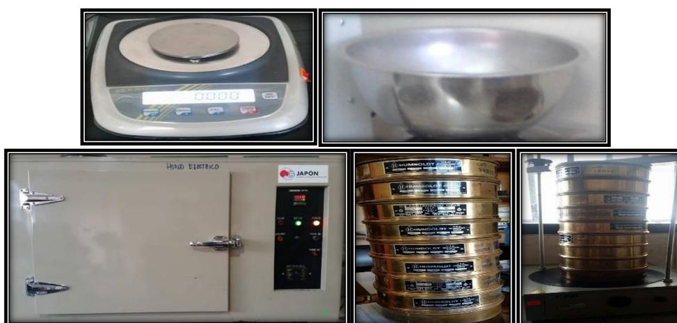
**Fotografía 3-4:** Instrumental para el Ensayo Granulométrico
