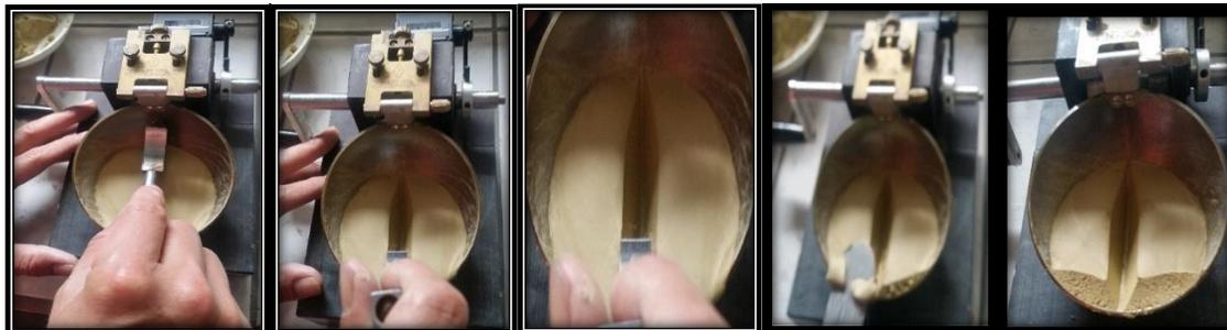
**Fotografía 18-4:** Ensayo del Limite Liquido (5)
