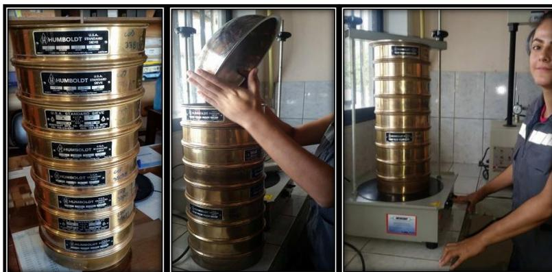
**Fotografía 11- 4:** Ensayo Granulométrico paso (8)
