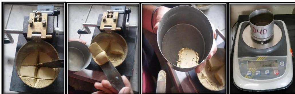
**Fotografía 20-4:** Ensayo del Limite Liquido (7)
