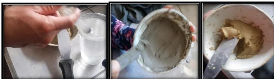
**Fotografía 24-4:** Ensayo del Limite Plástico paso (2)
