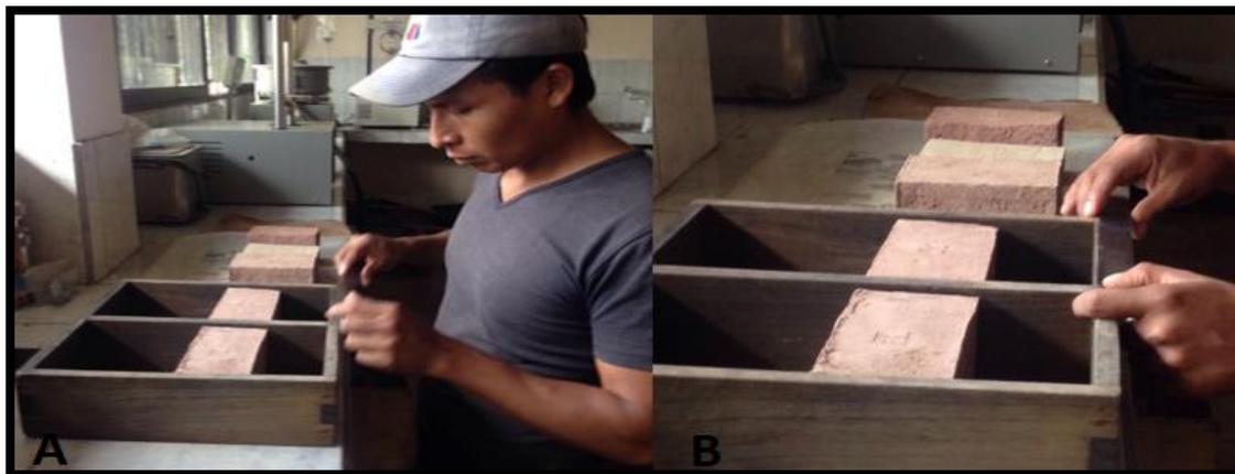
**Figura 3-15 Proceso de moldeo con la dosificación correcta**
