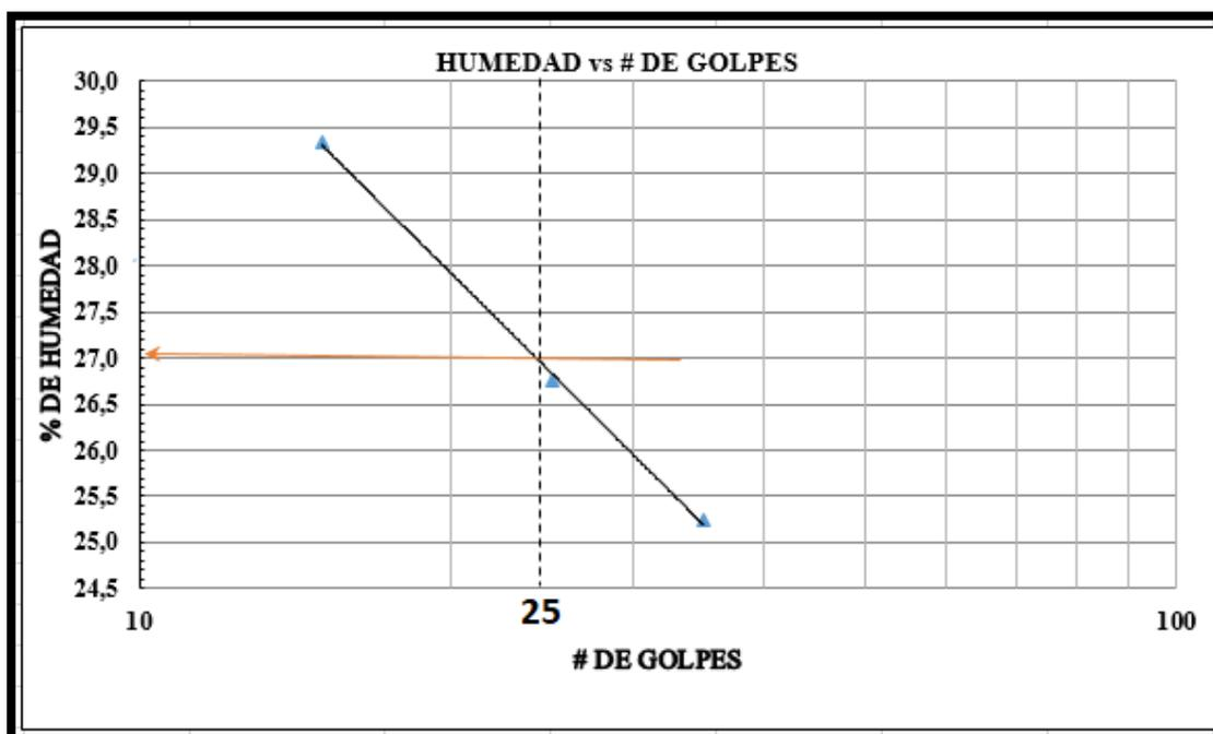
Figura 4-9 Grafica de Límite Líquido de la muestra M03
