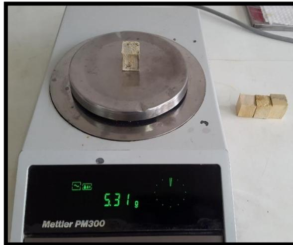
**Anexo 42.** Medición del volumen de agua absorbido de cada cubo de madera.
