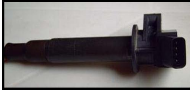
Figura 17-2. Bobina COP con modulo Incorporado
