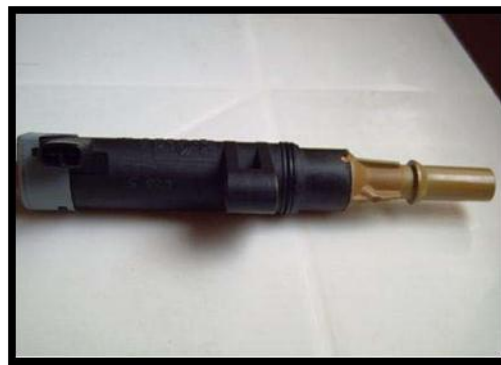
Figura 12-2. Bobina que se encuentra sobre el cilindro
