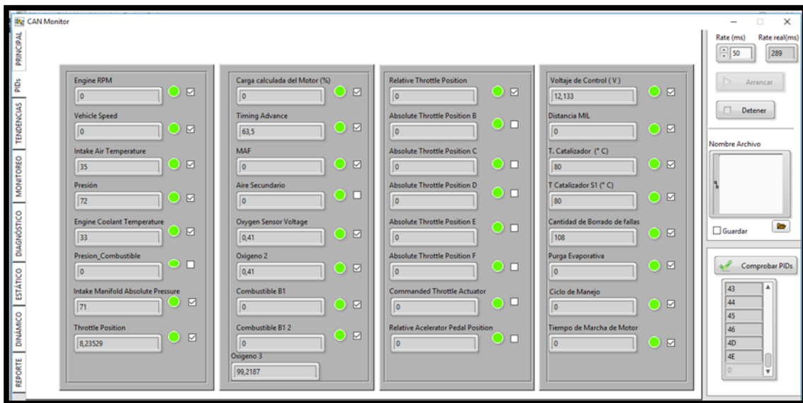
Figura 63-4 Pantalla de PID's deshabilitado el check Fuente: Santiana Cristian, 2017
