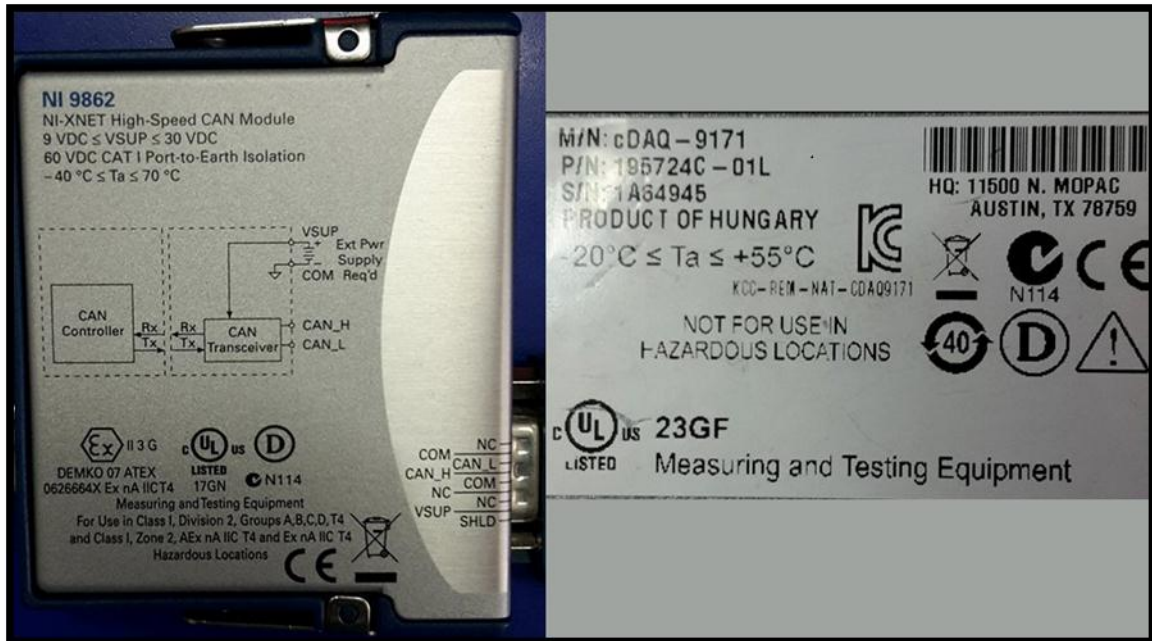
Figura 40-3. Tarjeta y Adaptador USB utilizado para la adquisición de Datos
