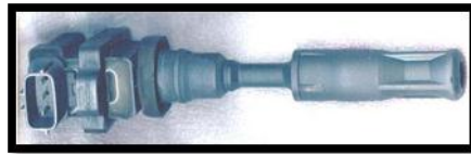
Figura 14-2. Bobina COP con transistor incorporado
