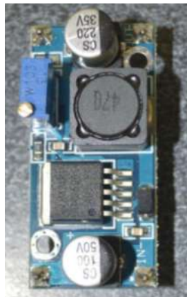
Figura 18-1: Regulador de voltaje
