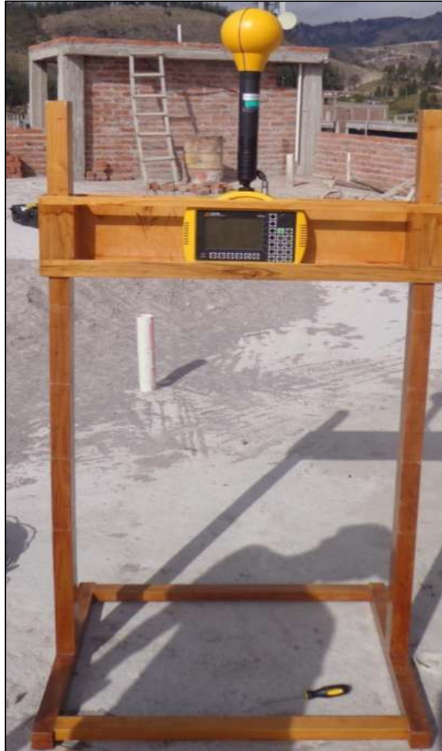
Gráfico 1-2: Soporte de madera para el equipo NARDA SRM-3000 de distancias ajustables. Realizado por: Avilés, E.
