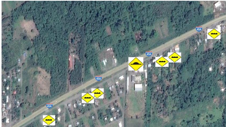
Gráfico 32: Implementación de BTA en la entrada de San Sebastián. Fuente: Google Maps
