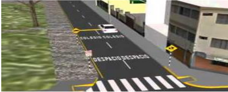
Ilustración 3: Rampa que coincide con el paso peatonal
