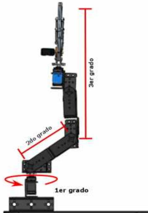
**Figura 17: Grados de libertad controlados en el robot: Vista lateral**
