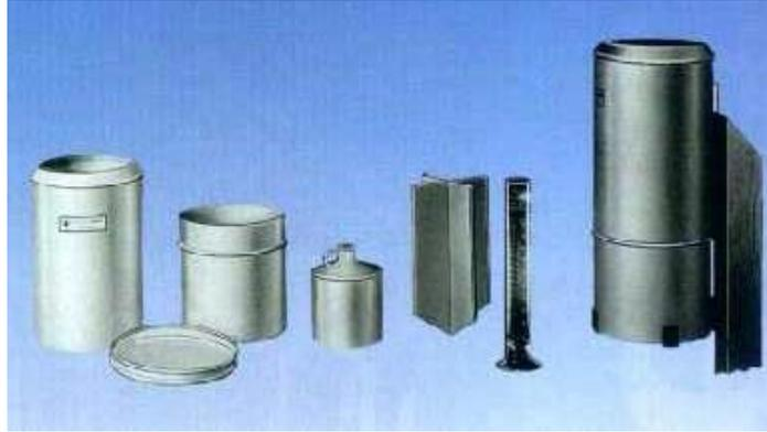
Fotografía 4-2 Pluviómetro
