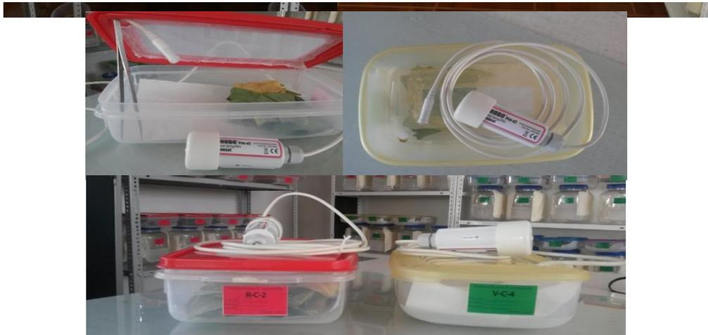
*Instalación de dataloggers en el interior de las cámaras (sensores de temperatura y humedad relativa).*
