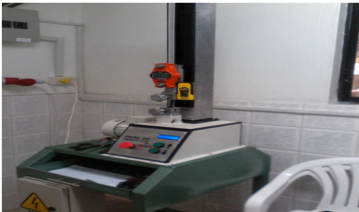
Fotografía 1. Máquina para el test de resistencia a la tensión.
