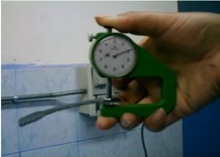
Fotografía 2. Equipo para medir el calibre del cuero.
