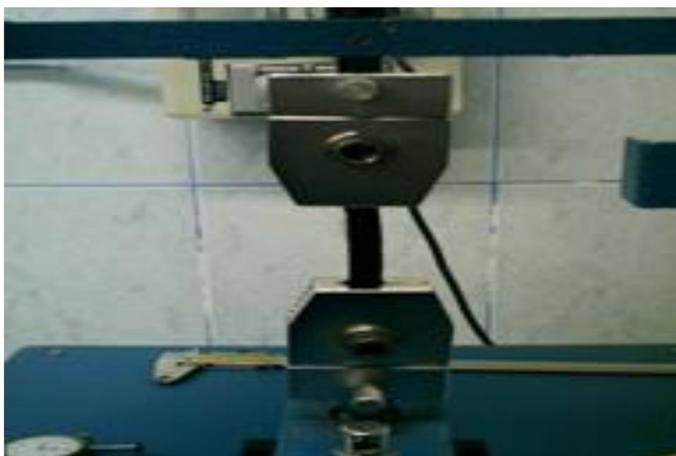
Fotografía 4. Colocación de la probeta de cuero entre las mordazas tensoras.
