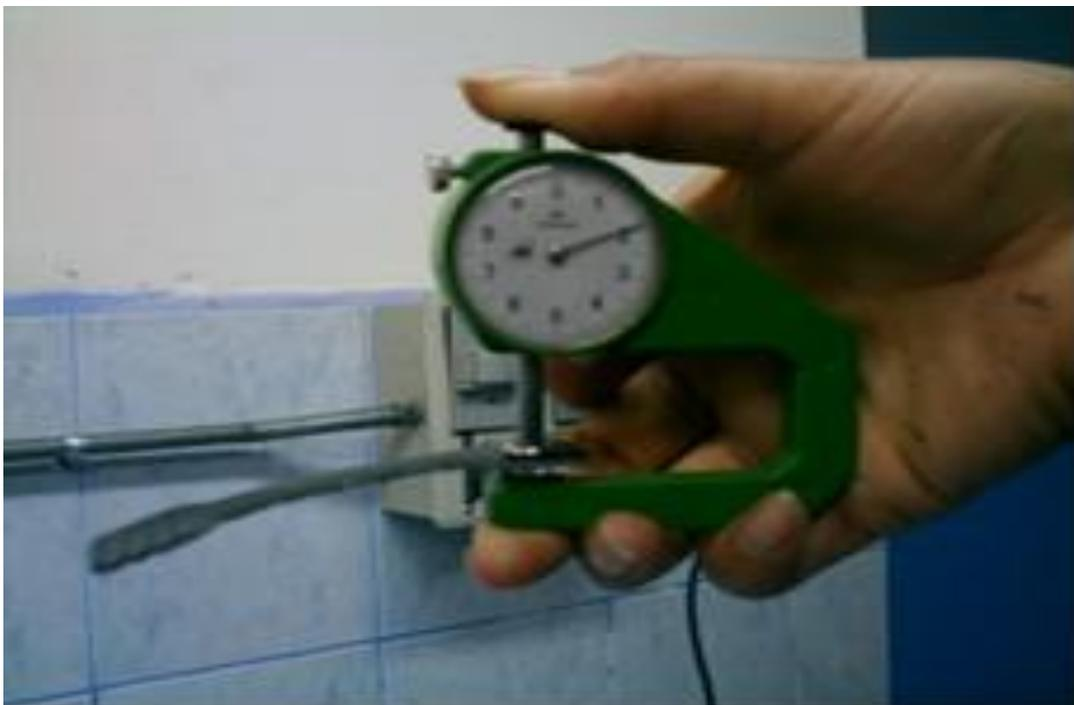
Fotografía 2. Equipo para medir el calibre del cuero.
