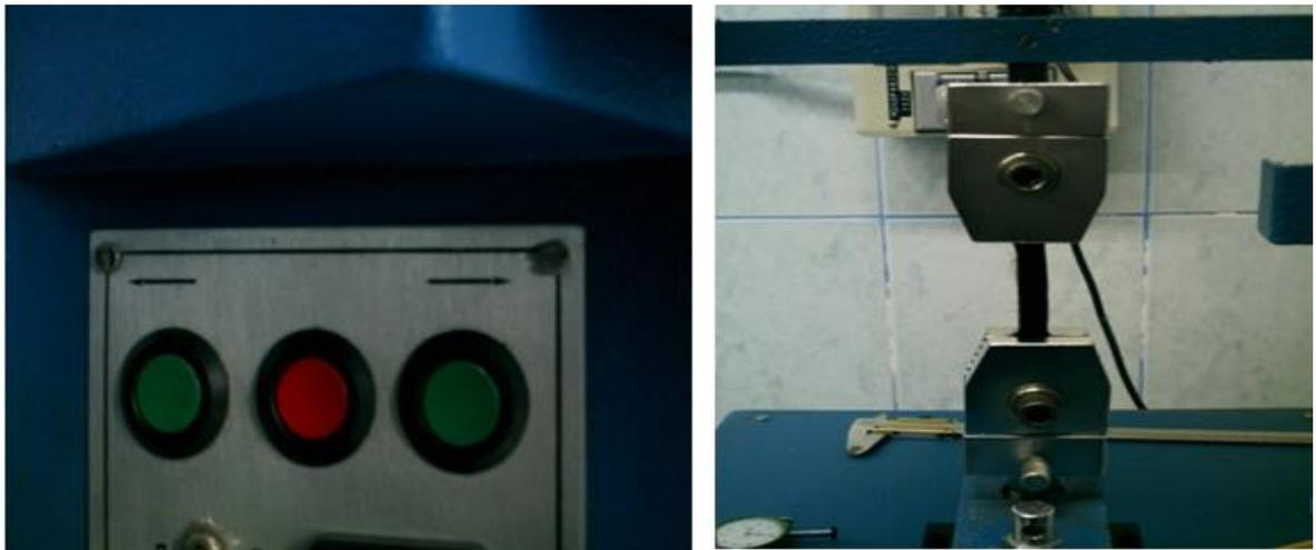
Fotografía 6. Puesta en marcha del prototipo mecánico para medir la resistencia a la tensión del cuero.
