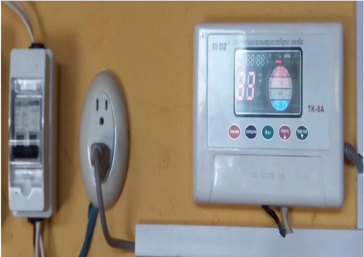
Fotografía 10. Control de energía del panel solar del prototipo mecánico BACH MIX.
