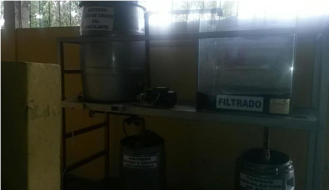
Fotografía 1. Prototipo mecánico de recuperación de cromo.
