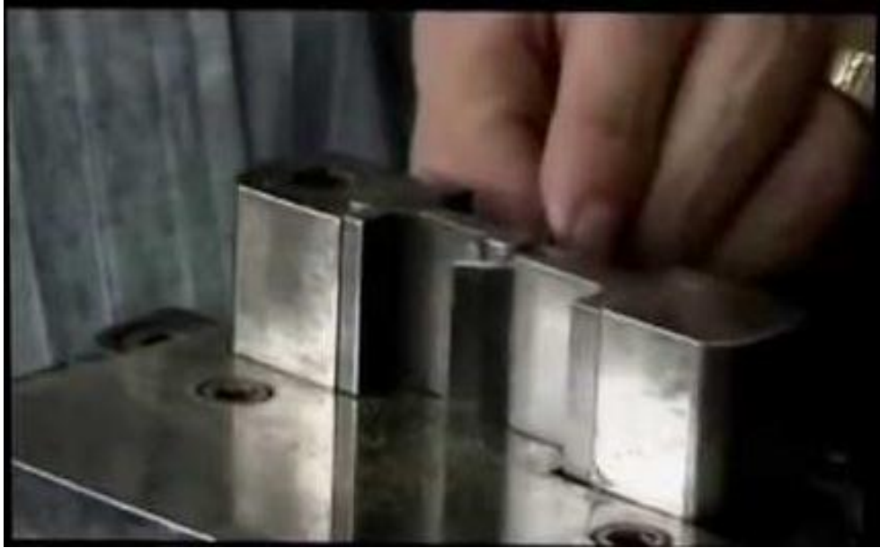
Figura 3. Troquel para realizar el corte de la probeta para el análisis de la resistencia a la tensión.
