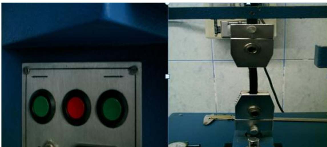
Figura 7. Puesta en marcha del prototipo mecánico para medir la resistencia a la tensión del cuero.
