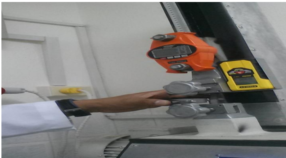
Figura 4. Equipo para realizar la medición de la resistencia al frote en seco.
