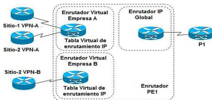
Figura 16-2. Enrutadores Virtuales creados en un enrutador PE1
