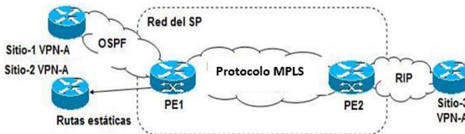
Figura 17-2: Intercambio de los protocolos de enrutamiento por VPN con el MPLS
