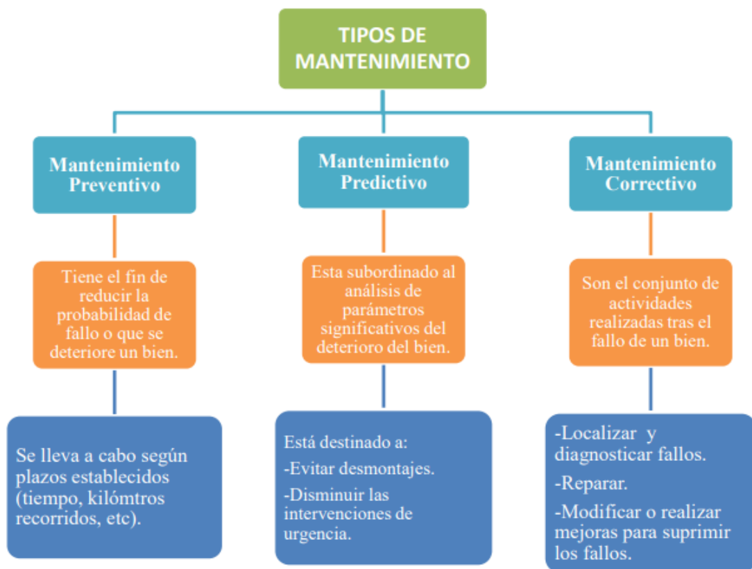
Figura 2-2. Tipos de mantenimiento
