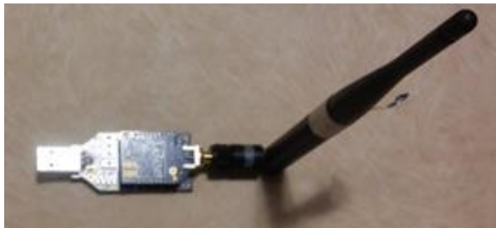
Figura 4-3 Montaje de la antena en el módulo XBee-PRO. Fuente: Autores
