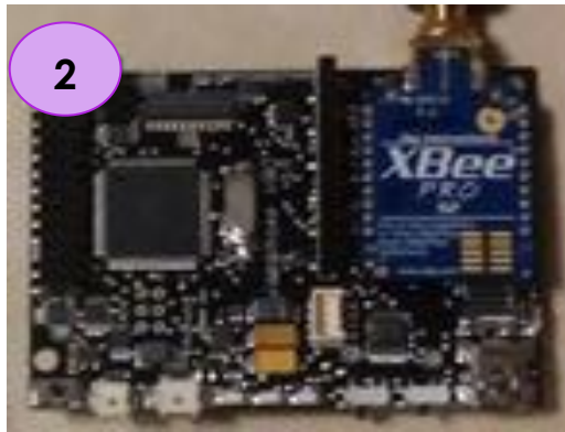
Figura 4-5 Colocación del XBee-PRO Serie 2 En la tarjeta Wasmote (Router). Fuente: Autores
