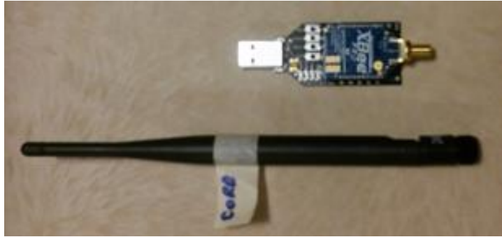
Figura 4-2 Montaje módulo XBee-PRO Serie2 en la placa Waspote Gateway USB. Fuente: Autores
